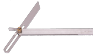
自由スコヤ スコヤの長手が任意の角度で固定できる。 図面から角度を写して使用する。
