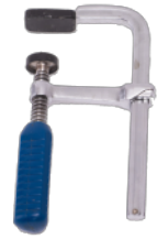
クランプ (万力) 材料を作業台に固定するときに使用。
